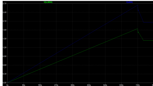
Figur 4.32: Graf från LTspice som visar spänningen över superkondensatorerna under uppladdning vid balansering med 500 \Omega motstånd.
