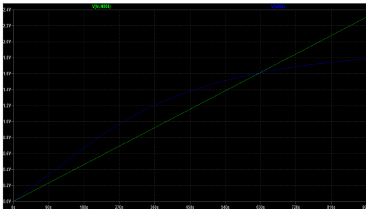
Figur 4.31: Graf från LTspice som visar spänningen över superkondensatorerna under uppladdning vid balansering med 5,6 \Omega motstånd.
